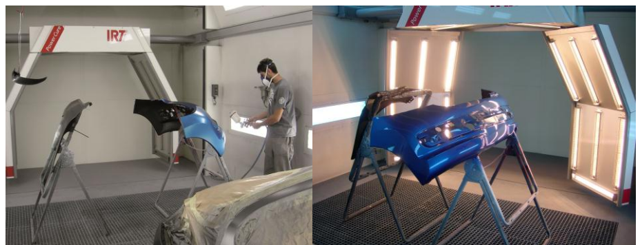
Peinture d'une pièce de carrosserie puis séchage infra-rouge (photos ADEME)
